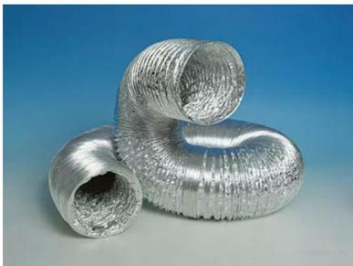
**Flexiver D** é a melhor opção, especialmente concebida e desenvolvida para realizar ligações das redes de condutas de distribuição de ar principais entre as máquinas e as unidades terminais das instalações térmicas de climatização dos edifícios. É a conduta flexível de secção circular da ISOVER, constituída por três camadas de um complexo de alumínio e poliéster, unidas por sobreposição e em espiral, com reforço de arame com tratamento exterior contra oxidação.
