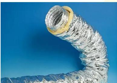
**Flexiver Clima** é especialmente indicada para as instalações térmicas em que é necessário um isolamento térmico que evite condensação. É a conduta flexível de secção circular da ISOVER formada por um tubo interior, isolado pelo exterior com um feltro de lã de vidro revestido com uma lâmina de poliéster e alumínio reforçado que confere resistência mecânica e actua como barreira de vapor.
