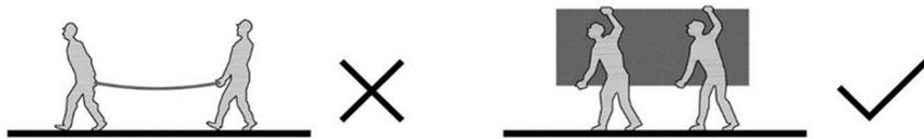
Siempre que sea posible, la manipulación de los paneles debe realizarse utilizando los equipos adecuados, como carretillas elevadoras o elevadores de paneles.
